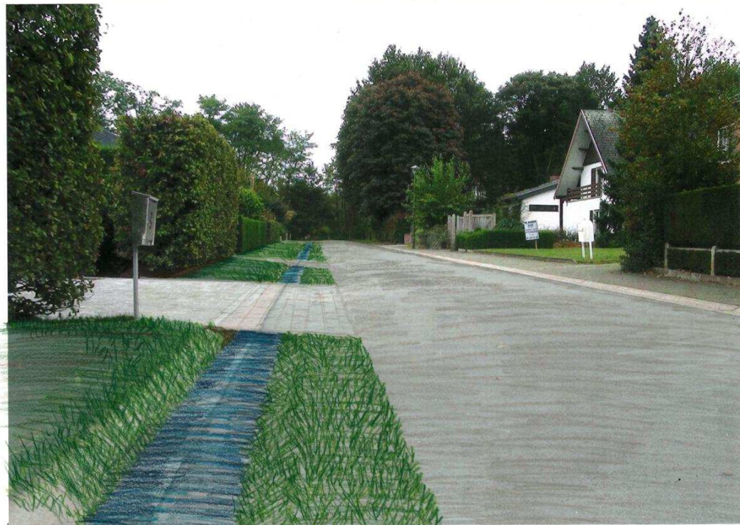
Figuur 58 Voorbeeld van de heraanleg van een gracht in een straat (te Wetteren) - bestaande versus geplande toestand
